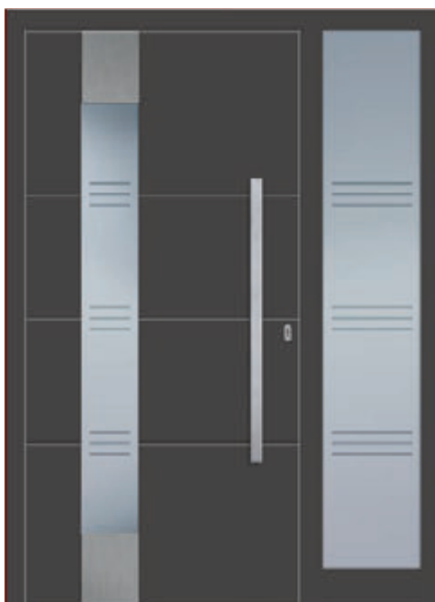
M-529 Ansicht B / DIN rechts J Applikationen in Edelstahloptik und Flachnuten außen ■ Aufsatzfüllung ■ Farbe Eisenglimmer ähnl. DB 703 Feinstruktur ■ Sandstrahlmotiv Y 1199 auf Klarglas | MG 3 ■ Griff ZAE 128, 1000 mm | PG 10 ■ Seitenteil Sandstrahlmotiv ST 1170 auf Klarglas
